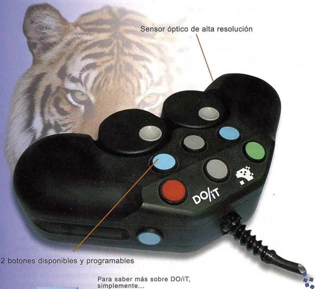
Sensor óptico de alta resolución
