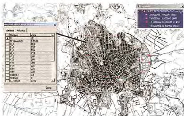
Descompensación de fases en centros de mandos
