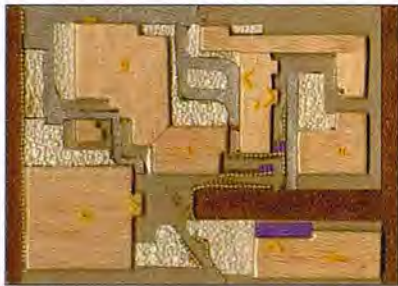
Fig. 4. Un ejemplo de molde listo para pasar por una máquina de termoformado (de Perkins, 2002).
